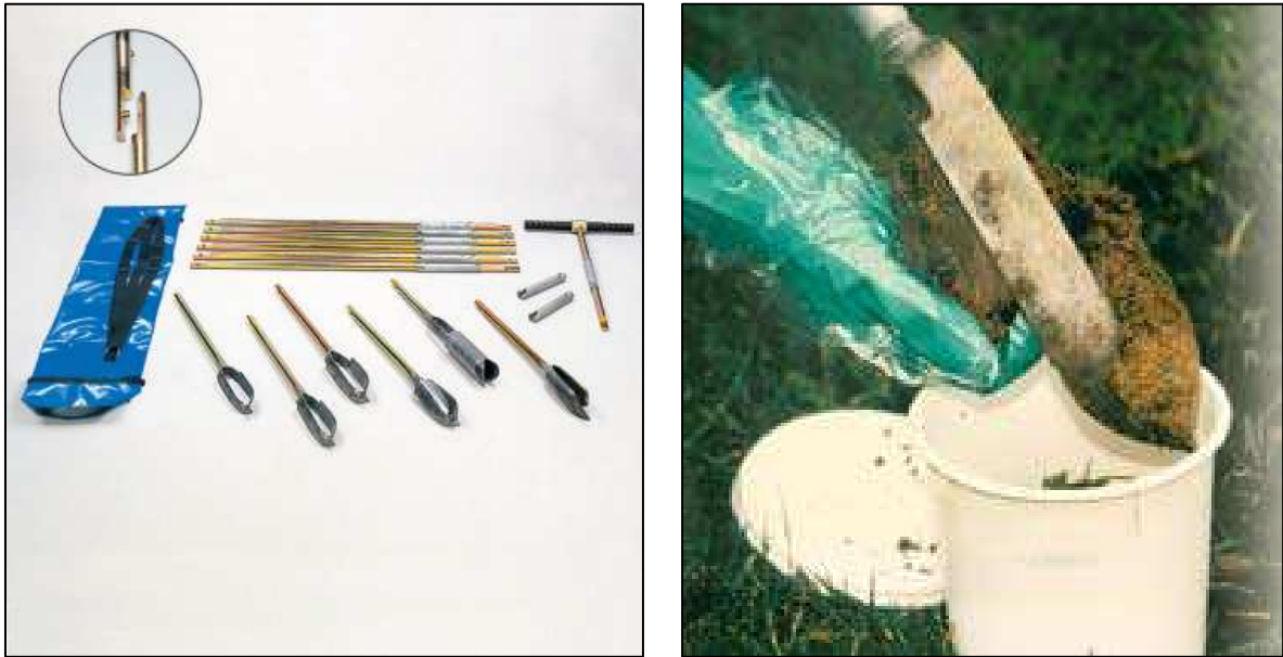
Kuva 5: Käsikäyttöinen näytekairakalusto (vas.) ja näytekairalla otettu maanäyte (oik.) (Eijkelkamp Agrisearch Equipment 2008).
