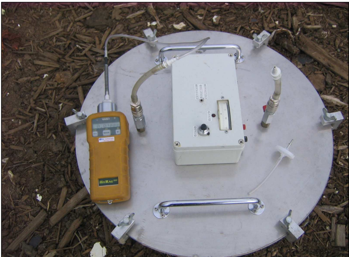
Kuva 13: VOC- pitoisuuden määrittäminen PID- analysaattorin sekä keräyshuuvun avulla.
