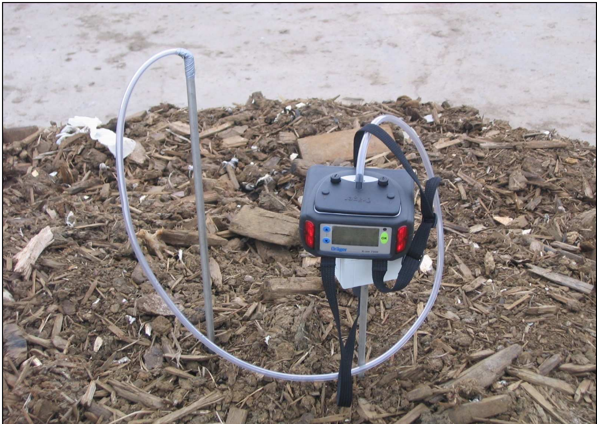
Kuva 12: Kaasumaisten yhdisteiden mittaus Dräger- monikaasuanalysointilaitteella.
