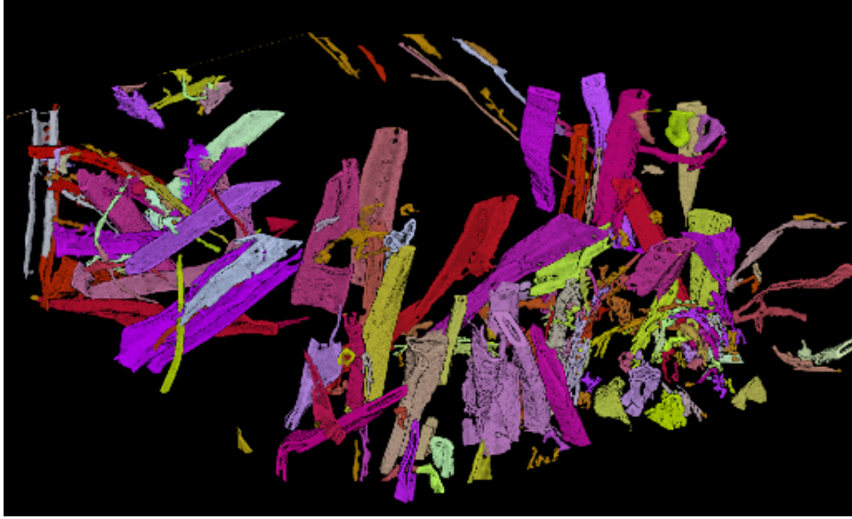
Kuva 12: Erotetut kuidut. Jokainen esitellyn algoritmin erottama kuitu on merkitty satumanvaraisella värillä. Käytetyt parametrit ovat (A_s, \alpha_1, \delta, \alpha_2) = (200, 15^\circ, 200, 30^\circ) .
