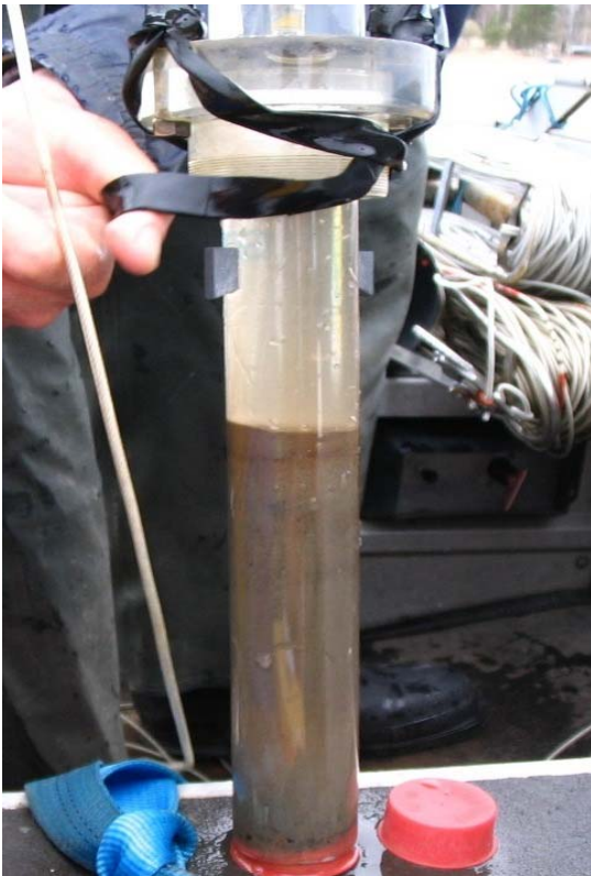
Kuva 15. a) Kajak-näyte b) Ekman-näyte. Kuvat ovat Vatianjärvestä (näytealue 15 km a ).
