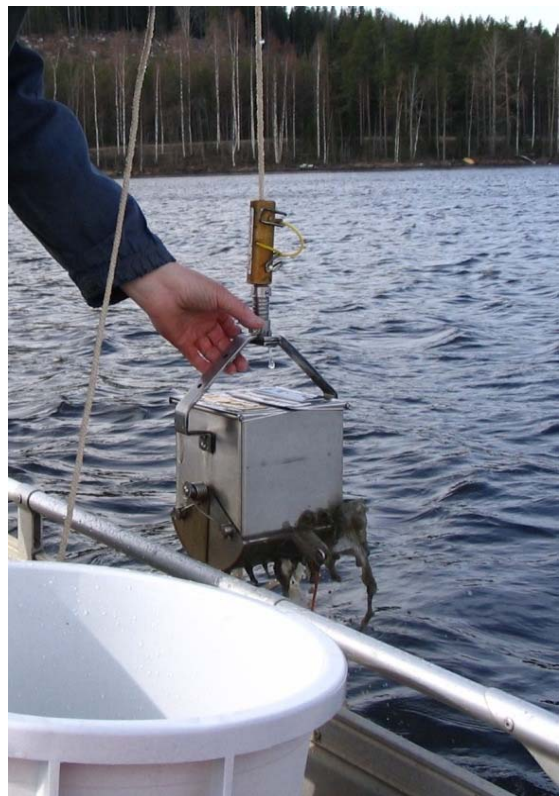
Kuva 15. a) Kajak-näyte b) Ekman-näyte. Kuvat ovat Vatianjärvestä (näytealue 15 km a ).
