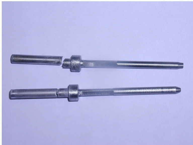
Kuva 28: Molybdeenistä valmistetut upokkaat tuhoutuivat yttrium-ajojen aikana.
