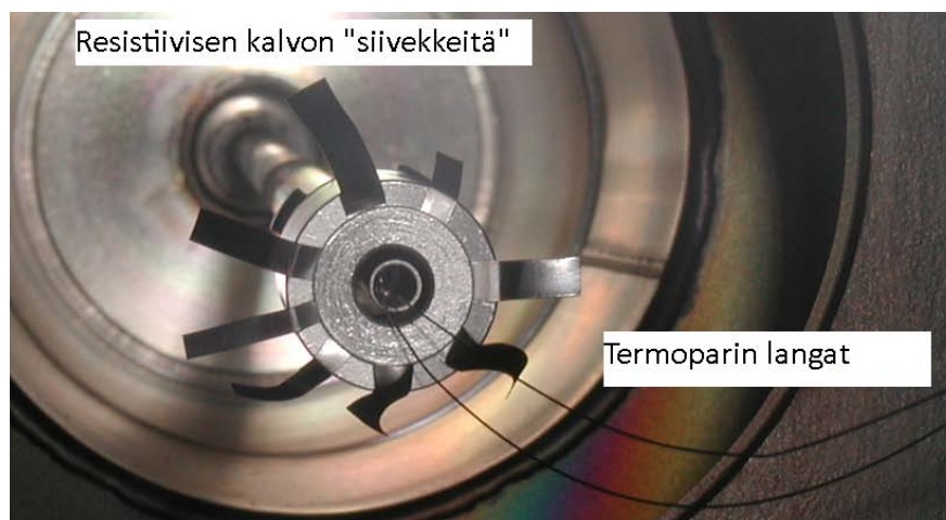
Kuva 21: Valokuva resistiivisestä uunista valmiina lämmitykseen kuvan 12 mukaisessa tilanteessa. Kuvasta voidaan nähdä oikealla termoparin langat, jotka menevät upokkaaseen sekä resistiivisen kalvon kiristyksessä käytettävät "siivekkeet".
