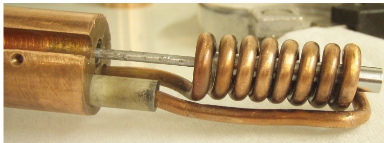
Kuva 10: Kehitteillä olevan induktiivisen uunin kela, jonka sisällä upokas sijaitsee.
