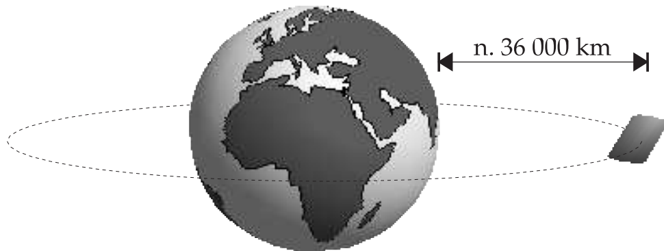
Kuva 3: Geostationaarinen kiertorata [3, luku Polaariset ja geostationaariset sääsatelliitit]
